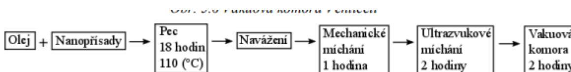
Obr. 5.7 Schematický postup výroby fluidního systému s nanopřísladami
