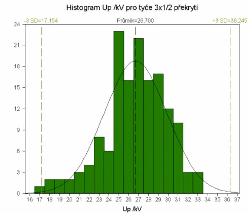
Obr. 10: Histogram  $U_p$  /kV pro tyče se způsobem izolování 3 x 1/2 překrytí
